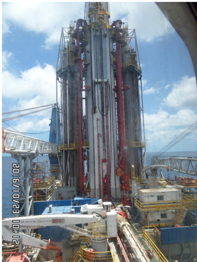
Фигура 10: Подемната система на Нобъл Глоубтрогър II (Източник: Шел)
