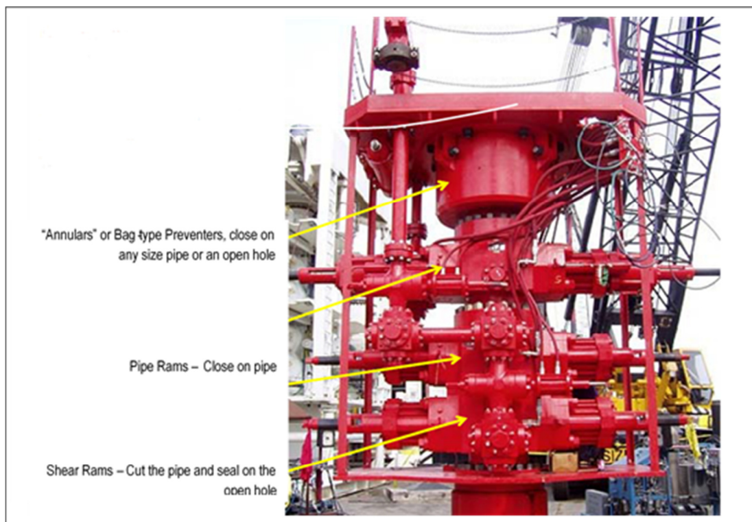
Фигура 4: Типичен противофонганен блок (Източник: Leimkuhler, 2010 г.)
