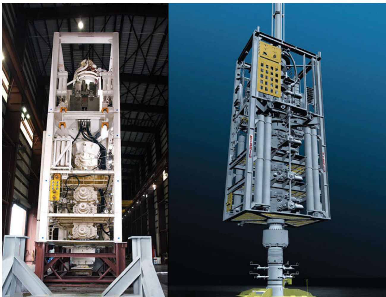
Фигура 5: Пример за дълбоководна затваряща стек система. (Източник: Шел)
